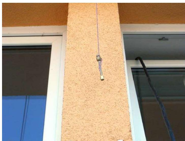
Obrázok 2: umiestnenie sorpčnej trubice na meranie benzénu
