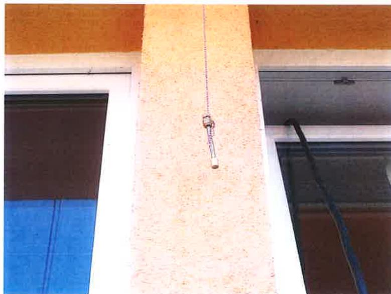
Obrázok 2: umiestnenie sorpčnej trubice na meranie benzénu
